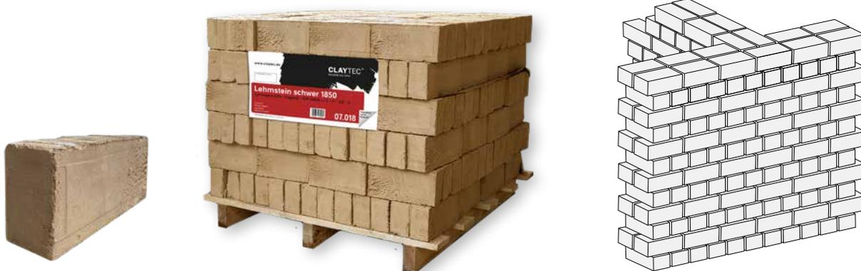
Schwerer formgeschlagener Lehmstein der Anwendungsklasse II für verkleidetes, witterungsgeschütztes Außenmauerwerk und jede Art von Innenmauerwerk. Der Lehmstein schwer 1850 ist ein ungelochter Vollstein. Er ist für tragendes Lehmsteinmauerwerk geeignet und erfüllt die Druckfestigkeitsklasse 2 nach DIN 18945. Durch die innere Gefügefestigkeit, die Formgenauigkeit und das handliche Format ist er besonders gut zu vermauern. Als Mörtel ist CLAYTEC Lehm-Mauermörtel schwer geeignet.
