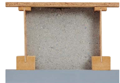
Sparrenexpander in Dämmplattenstreifen eingesteckt!
