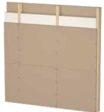
Trockenbauplatte aus Lehm zum Beplanken von Holz- und Metallständerkonstruktionen von Innenwänden, Vorsatzschalen, Decken- und Dachflächen. Die Lehmbauplatte schwer bringt viel Lehm ins Haus, mit allen positiven Auswirkungen für das Raumklima, besonders in thermischer Hinsicht. Sie ist leicht zu schneiden und erlaubt ein weites Trockenbau-Unterkonstruktionsraster von 62,5 cm.
