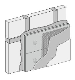
Holzfaserdämmplatte für die Innendämmung von Fachwerkhäusern und allen anderen Altbauten. Die CLAYTEC HFD Innendämmplatte wird flächig in eine Lehmputz-Ausgleichlage geklebt oder mit Lehmklebe- und Armierungsmörtel befestigt. Die weichen Platten entkoppeln Verformungen der Konstruktion vom Innenputz. Sie sind preisgünstig und für viele Außenwandarten geeignet.
