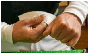
3. Das Band über die Finger legen den Liner durch leichten Zug aufreißen
