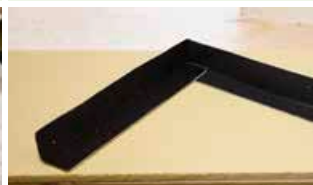
6. Den Klebestreifen aufklappen und die geklebte Innenecke zur Seite falten
