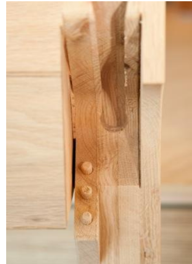
Abb. 2) Drei Dübel sind im Fußteil zu sehen, zwei im Kopfteil, danach richtet sich die Richtung des Seitenteils!
