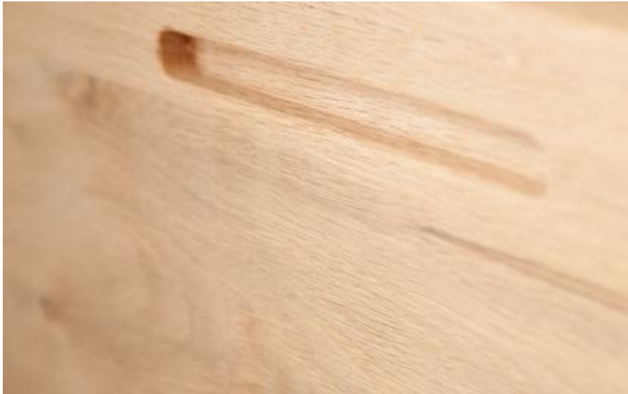
Abb. 2 Abbau) Ausfräsung links und rechts in Kopf- und Fußteil, ca. 20 x 2 cm.
