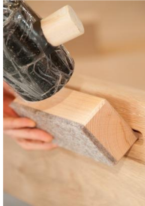
Abb. 3 Abbau) Das Klopffholz in die vorgesehene Einfräsung einfädeln und in Richtung Fußboden klopfen.
