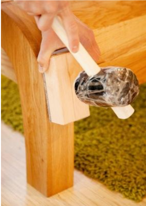
Abb. 6) Die beiden Komponenten Seiten- und Fußteil rutschen durch einfache Hammerschläge leicht zusammen.
